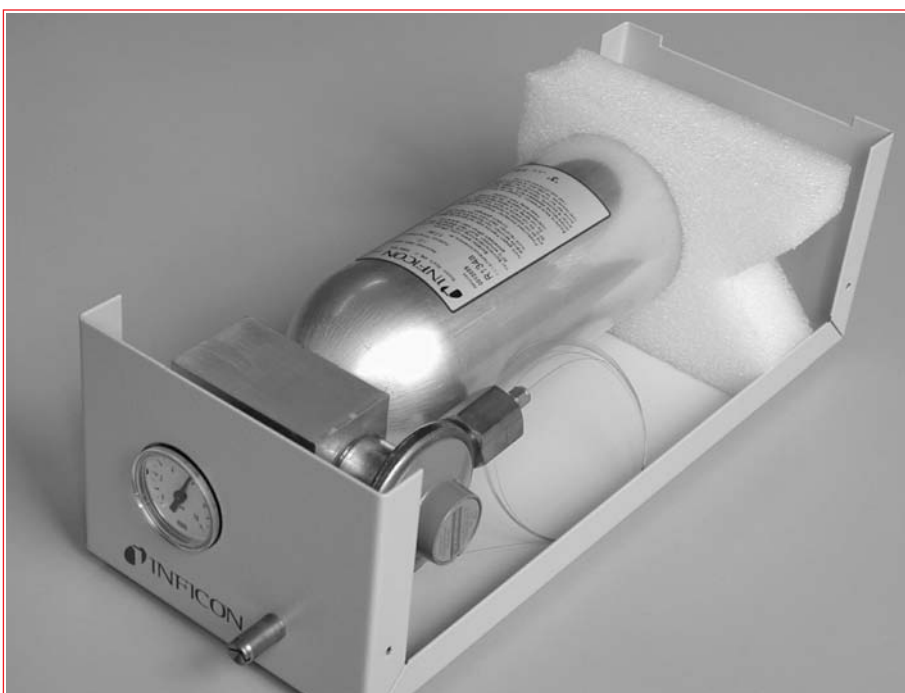
Abb. 9.11 Schnüffel-Prüfleck mit Druckregler
