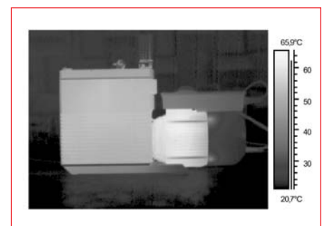
Abb. 2.73 Temperaturverteilung EcoDry M im Zyklusbetrieb
